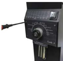
图9.2-拆除刻度盘前盖
